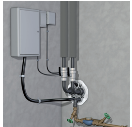
Mehrspartenhausanschluss mit Fernwärme
