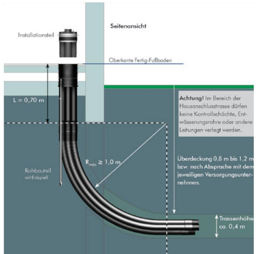
Das Installationsteil ist die eigentliche Dichtung der MSH und wird erst beim Leitungseinzug benötigt.
